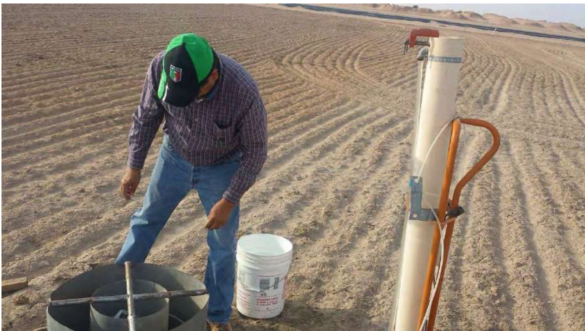
Anexo 4. Toma de infiltraciones
