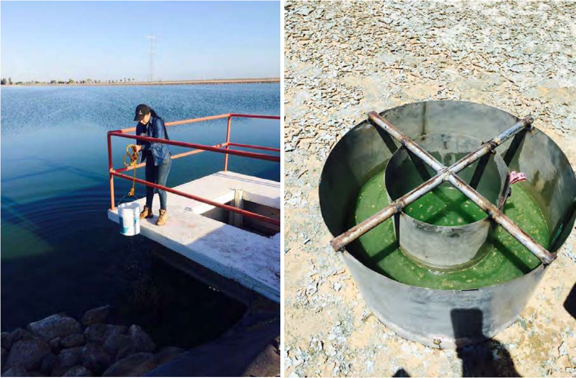
Anexo 1. Pruebas de infiltración con agua residual tratada, después de la remoción de los 25 cm
