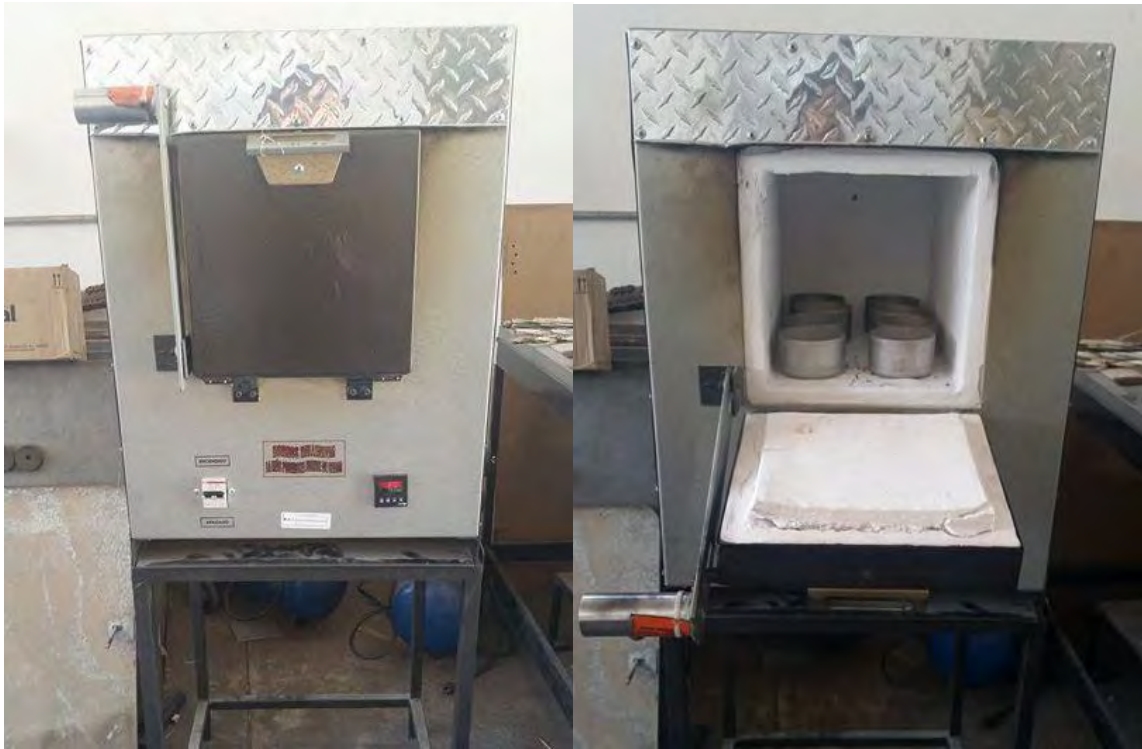
Anexo 3. Muestras en mufla para determinar porcentaje de materia orgánica
